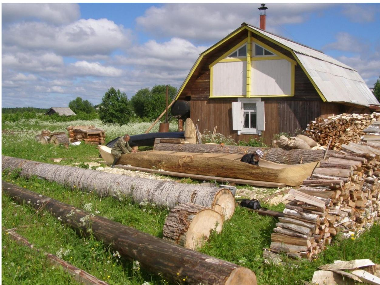
Параметры «морской» лодки: длина – 8 м, максимальная ширина – 1,2 м, высота бортов 40–45 см, вес – около 200 кг, грузоподъёмность – более 1,2 т. По имеющимся у нас данным, лодка таких размеров построена на Архангельском Севере впервые за два последних столетия.
